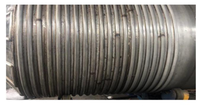
一般厂家会采取用不锈钢来对半圆管进行加工,它自身可以减少加热时的腐蚀性。在焊接的时候,所需求
