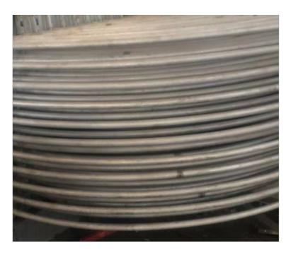
半圆管具有不锈性、耐蚀性、美观性、可回收等特性,在实际应用中,可以进一步体现其节能减排的社会效益。那么它在应用之前所进行冷却定型处理有哪些方法? 1、真空法采用管外抽真空的方法,则可以使管材外表面,吸附在定型套内壁,冷却定外径尺寸的方法。2、内压法半圆管内加压压缩空气,管外加冷却定型套,使管材外表面贴附在定型套内冷却硬化定外尺寸的方法,管材经牵引装置均匀引出。3、顶出法顶出法是不用牵引装置,直接将其顶出成型。以上就是有关半圆管的冷却定型的一些方法,对此信息大家有需要咨询其他的内容,可以咨询我们的客服。
